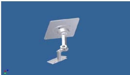
**Figura 5.** Vista posterior del soporte para chasis radiográfico creado de manera virtual.
