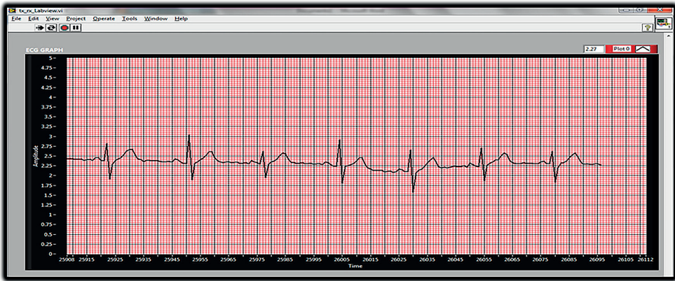
Figura 9. Primeras pruebas de la señal cardíaca adquirida en el PC con el software Labview Fuente: elaboración propia.
