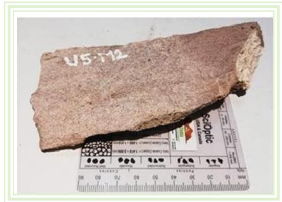
Figura 9. Arenisca Limosa con estructura masiva, muestra 2 de la unidad 5.
