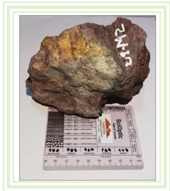
**Figura 3.** Limolita masiva, muestra 2 de la unidad 1.
