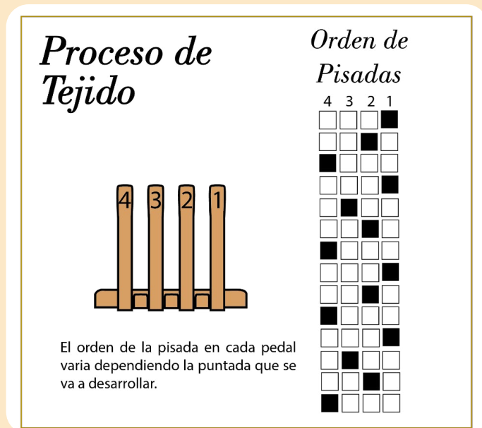
FIGURA 25. ORDEN DE PEDALES PARA EL PROCESO DE TEJIDO PARA “ESPIÑA DE PESCADO”.
