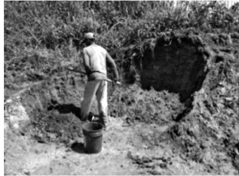
Para el acopio, la materia prima se transporta en carretilla, eventualmente se utiliza retroexcavadora, debido a que no se cuentan con los recursos para que el uso de la retroexcavadora sea permanente, una vez transportado el material se acopia en el lote, donde queda expuesto a la intemperie, cuando humedece la materia prima, se hace más modelable.
