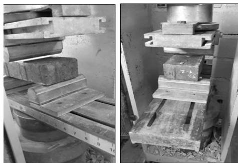
Figura 13. Montaje para ensayo de flexo-tracción a 28 días.
