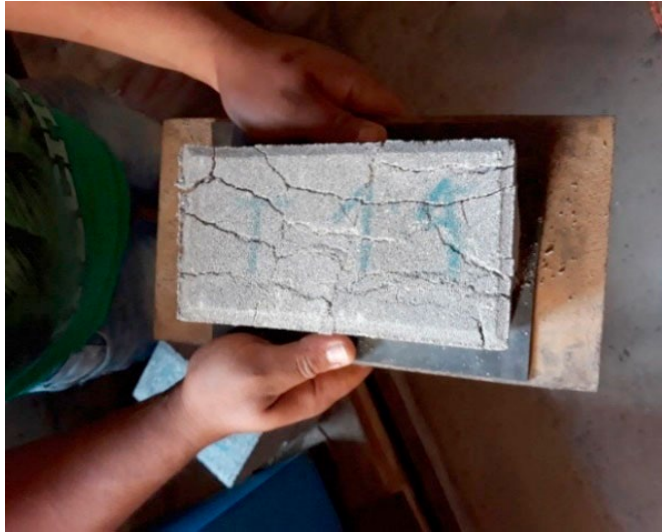
Figura 17. Resultado patológico al fallar por compresión el adoquín.
