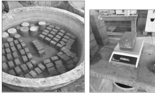
Figura 11. Saturación por 24h y pesaje de los adoquines.
