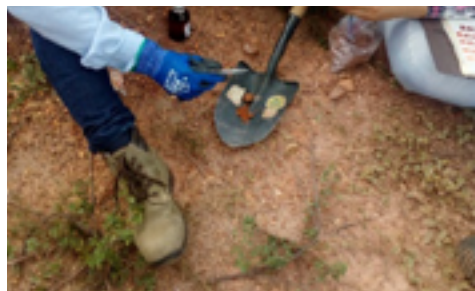
Figura 9. Determinación de la presencia de Carbonatos en el suelo
