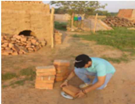
Figura 9. Proceso de pesaje de la muestra aleatoria tomada en el horno escogido estratificadamente Fuente: elaboración propia.
