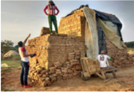
Figura 8. Horno en el que se ubican 10 000 ladrillos de los cuales se escogieron 10 de manera aleatoria Fuente: elaboración propia.
