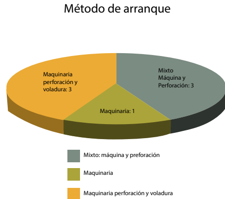
Figura 4. Método de extracción del sistema a cielo abierto tipo cantera del recurso de la roca caliza en el norte del departamento del Cesar
