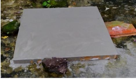
Figura 7. Concreto con esterilla de la palma zancona
