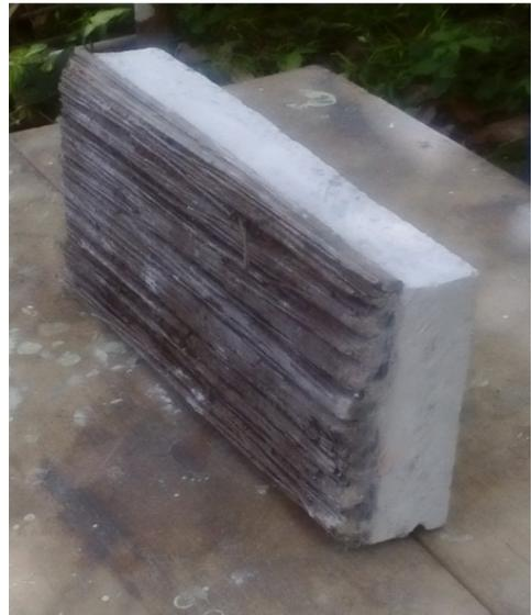
Figura 8. Probeta con la combinación de palma y concreto
