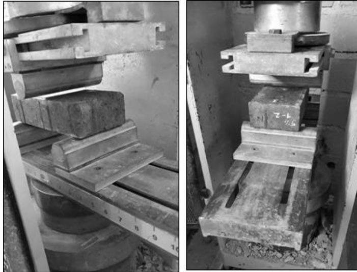
Figura 4. Montaje para ensayo de flexo-tracción a 28 días
