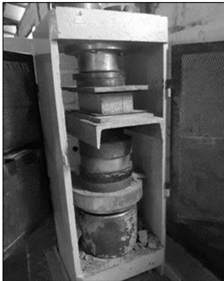
Figura 7. Montaje para ensayo de Compresión a 28 días
