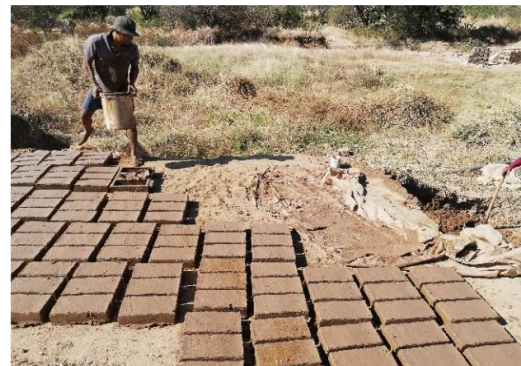
(b) Muestras posterior al desmoldado, antes del proceso de cocción
