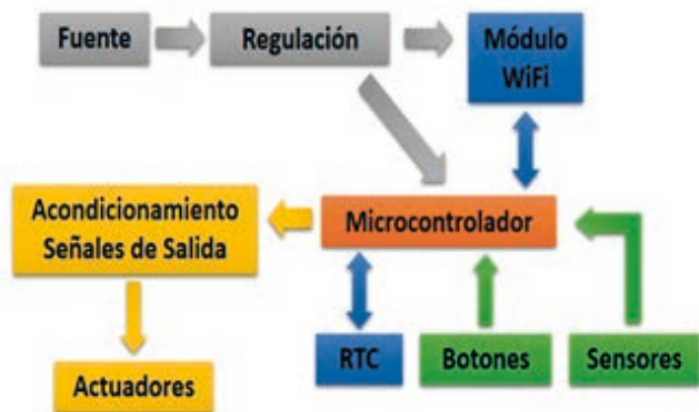
Figura 3. Diagrama de bloques de la tarjeta de control.
