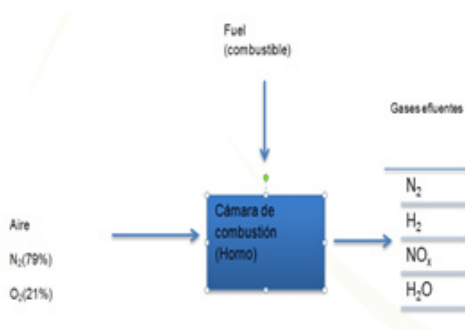
Figura 5. Diagrama proceso cocción de ladrillo. Fuente: elaboración propia
