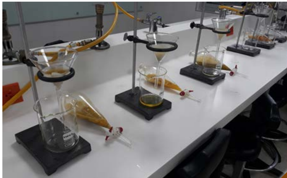
Filtración con arrastre por solvente
