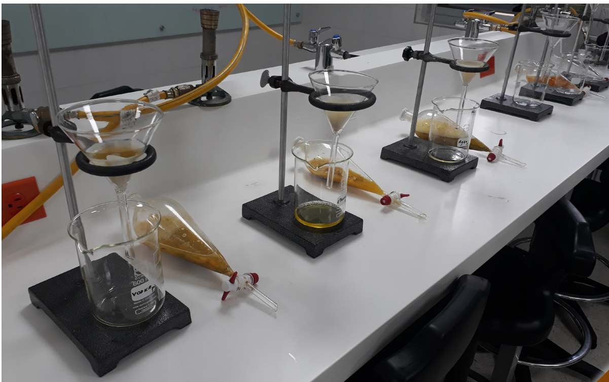
Filtración con arrastre por solvente
